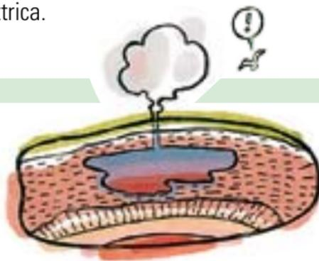
L'acqua calda così ottenuta si sfrutta nelle terme, per scaldare serre e allevamenti di pesci o addirittura interi quartieri. Se supera i 100 gradi è vapore: allora la si usa invece per azionare turbine e fare elettricità nelle centrali geotermoelettriche, come a Larderello in Toscana.
